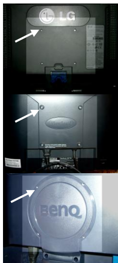
Фото 3: монтажные отверстия мониторов
